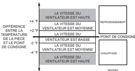
**Fig. 28. Algorithme de rampe de ventilateur VersaSpeed™.**
