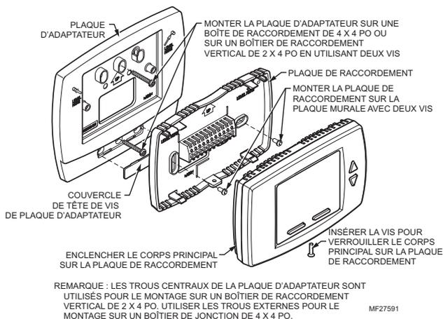
**Fig. 3. Montage de la plaque de raccordement et du thermostat avec la plaque d'adaptateur (50033847-001).**
