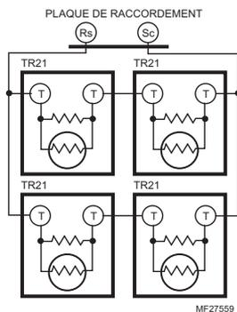
Fig. 4. Câblage de quatre capteurs TR21 (20 K ohms).
