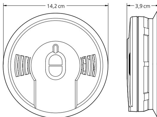
Cette unité doit comporter une fonction Avis de fin de vie, indiquant que l'avertisseur a besoin d'être remplacé. L'unité « retentit » une fois toutes les 40 à 45 secondes durant un minimum de trente (30) jours à la fin de sa durée de vie. L'unité doit être munie d'un interrupteur de désactivation pour la désactiver et ainsi en permettre l'élimination en sécurité.
