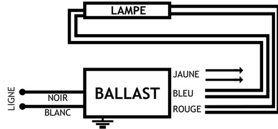
Les fils jaunes doivent être raccordés au connecteur de type-plongeur
